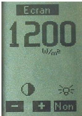
Régler le contraste et activer le rétroéclairage
