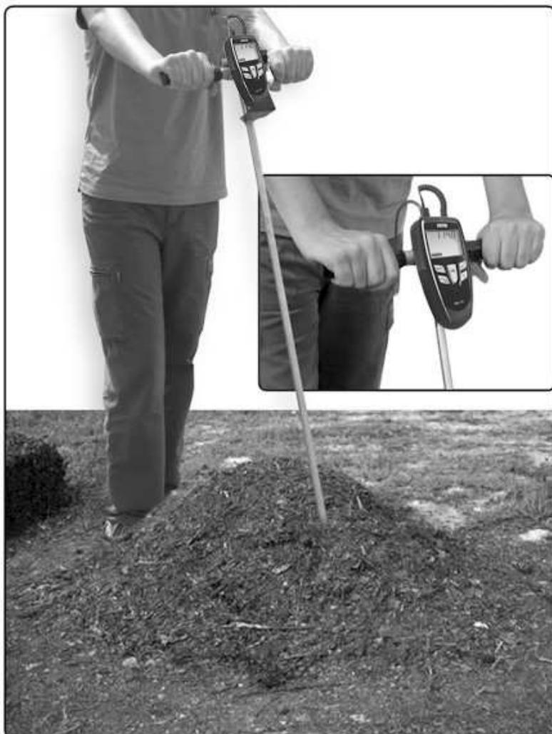
Les sondes de température “**Spéciales compost**” permettent d’effectuer des mesures de température dans des milieux spécifiques tels que :
