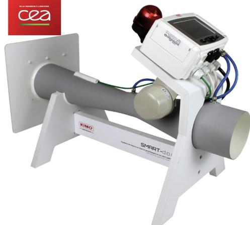
Systeme de **M**esure et **A**larme garantissant la non **R**éTrodiffusion – **D**ismantling **O**perations **G**uarantee
