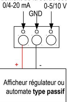
> Raccordement de la sortie tension 0-5/10 V :
