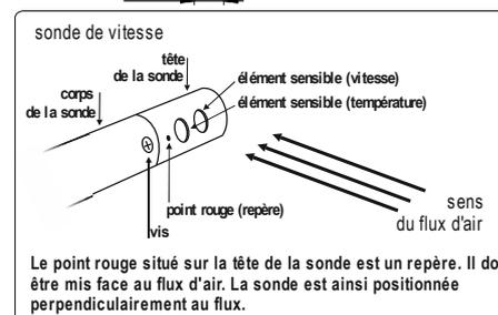
Le point rouge situé sur la tête de la sonde est un repère. Il doit être mis face au flux d'air. La sonde est ainsi positionnée perpendiculairement au flux.
