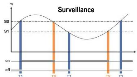
L'alarme se déclenche lorsque la mesure est en dehors du seuil haut et du seuil bas.
