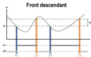
Mesure (m) < Seuil (S) pendant la temporisation T1 → Activation de l'alarme.
