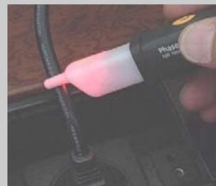
Détection de tension alternative (AC)
